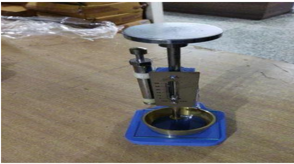
Fig 1: Vicat test apparatus
